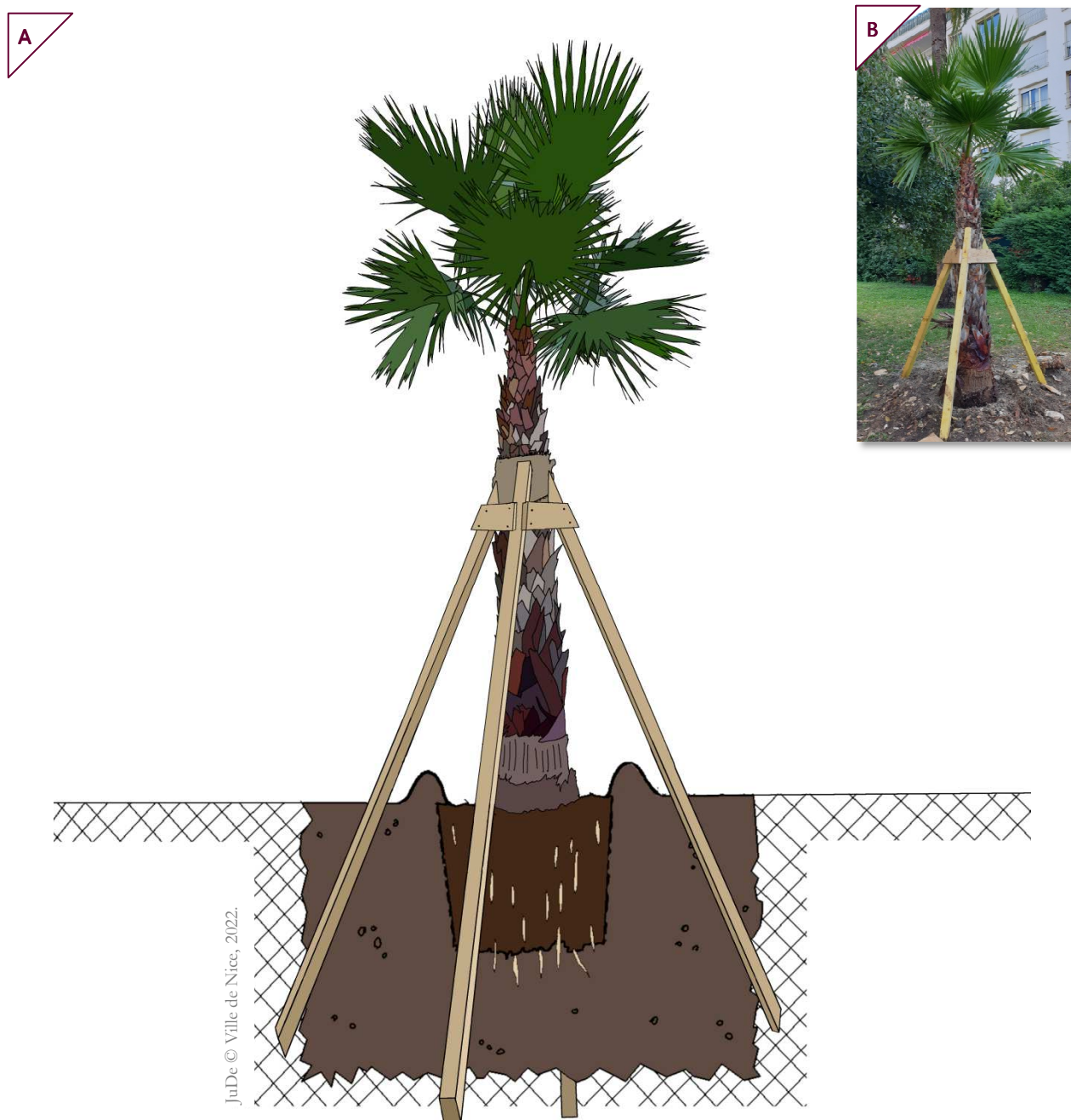
Figure 24. Tuteurage en tipi sur Palmier jupon ( Washingtonia sp. ). (A) Schéma. (B) Parc Vigier, Nice.
